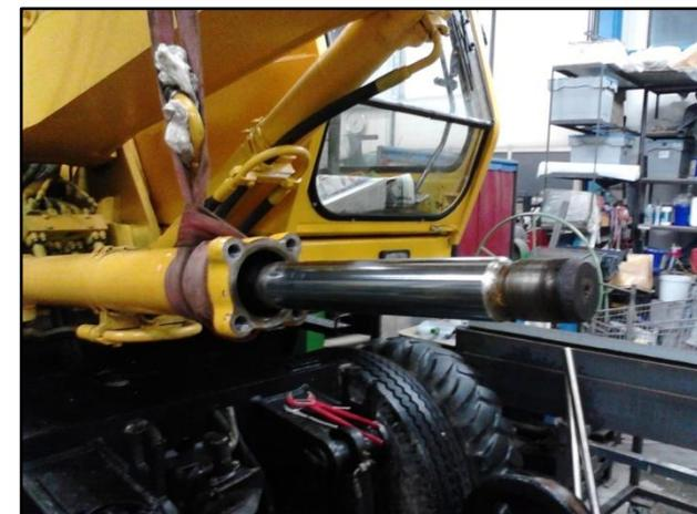
*Links: Zylinder ist ausgehängt und wir für die Zerlegung vorbereitet.
