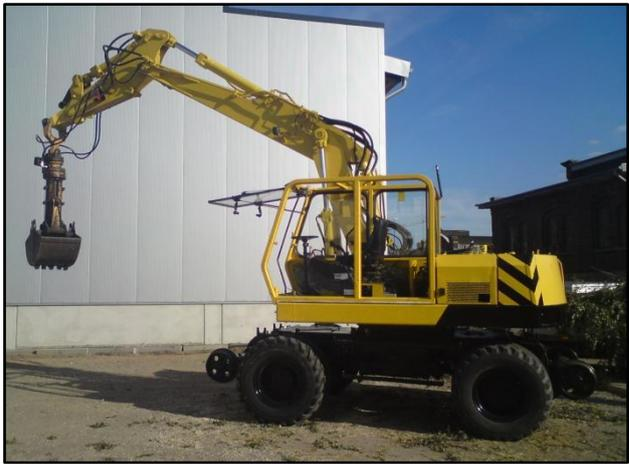
*Links: Der fertig lackierte Ober- und Unterwagen mit neuen Reifen und vielen bereits wieder angebauten Anbauteilen;
